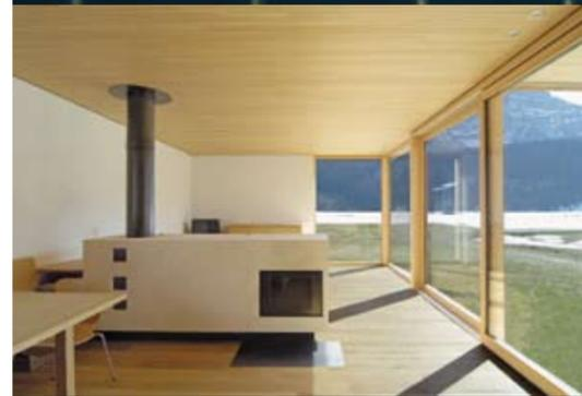
Nadelstreifholz ist eine von uns entwickelte Bauweise für Wände und Decken. Heimisches Massivholz wird gehobelt, gepresst und insich verdübelt. Die Oberflächen dieser Bauteile spiegeln die natürliche Schönheit des Holzes. Unsere Wände und Decken gestalten wir je nach Kundenwunsch, die Möglichkeiten der Oberflächengestaltung sind unbegrenzt.
